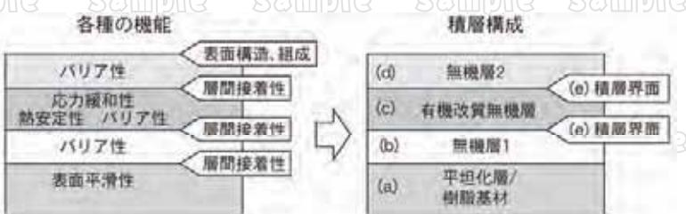
図2-18 バリアフィルムの積層設計(コニカミノルタ)
