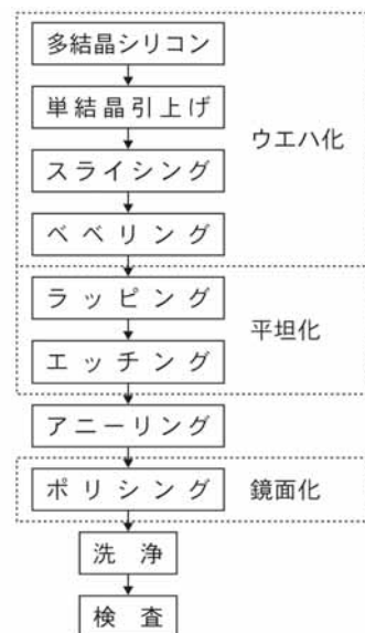
図3-7 シリコンウエハの製造プロセス
