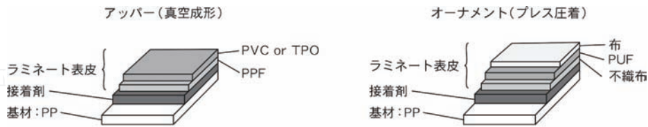
図2-4 ドア加飾部の構造
